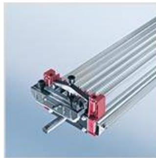
Sefar bezieht für das Verarbeiten anspruchsvoller Kettgarne Webereizubehör von Groz-Beckert. Für höchste Webdichten werden 12-reihige Kettfadenwächter eingesetzt. Kohlefaserverstärkte Hybrid-Webschäfte von Groz-Beckert ermöglichen es Sefar, in Breiten bis 430 cm ohne störende Zwischenstreben zu
