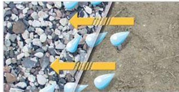
Die richtigen hydraulischen Eigenschaften eines Geotextils sichern die Feinteile, während Wasserdurchfluss zugleich möglich ist; © Fibertex
